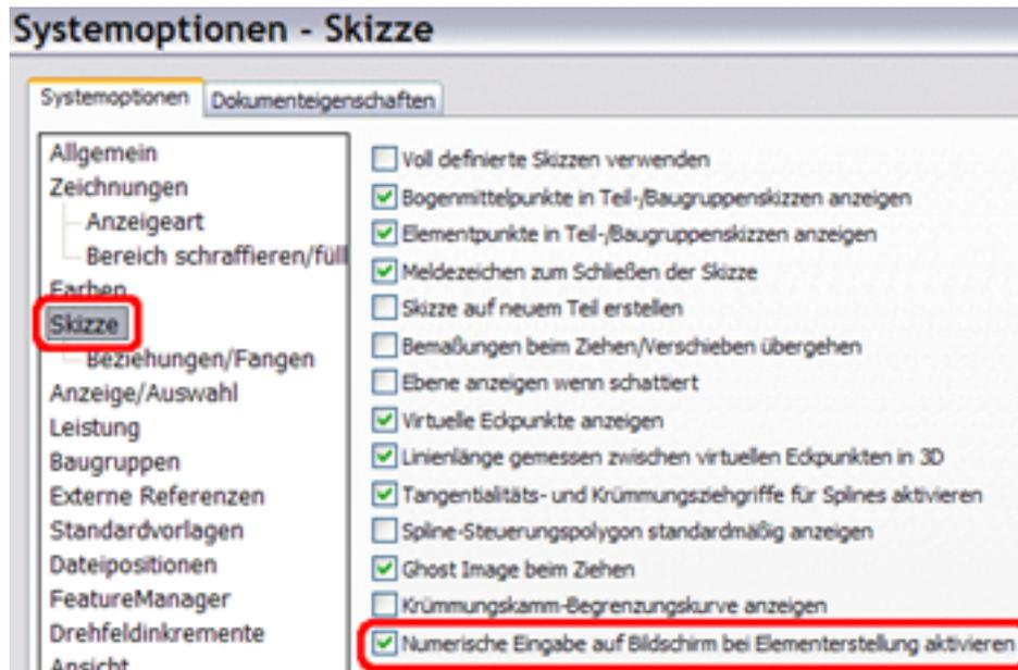
1.2. Erstellen eines Skizzenelementes. Bemaßung wird nun automatisch hinzugefügt. Die Werte können sofort eingegeben werden und mit Enter bestätigt. Durch die Bestätigung wird automatisch die jeweils nächste Bemaßung aktiv und es kann der Wert eingegeben werden. Wenn Sie zwischen den Bemaßung selbst umschalten möchten so kann dies über die Tab-Taste erfolgen.
